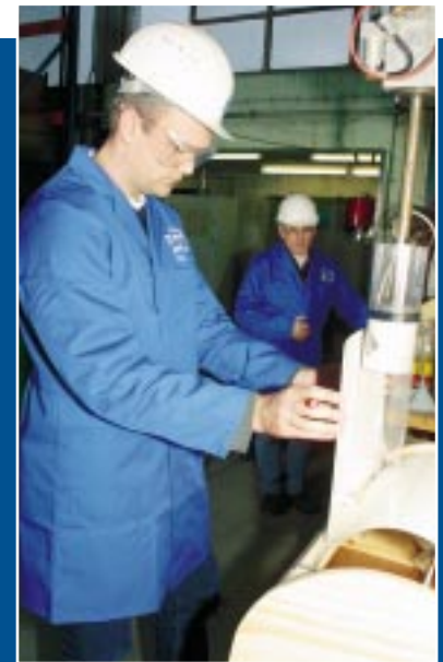
Schlagfertig: Bei der niederländischen Materialprüfungsanstalt TNO lässt sich selbst bei schönstem Wetter jeder noch so katastrophale Hagel erzeugen. Der Simulator verschießt mit Druckluft Nylonkugeln, die in ihrer Wirkung natürlichem Hagel sehr nahe kommen. Normalerweise geht es bei den Versuchen um die Widerstandsfähigkeit von Gewächshäusern – diesmal kamen Caravandächer unter Beschuss.
